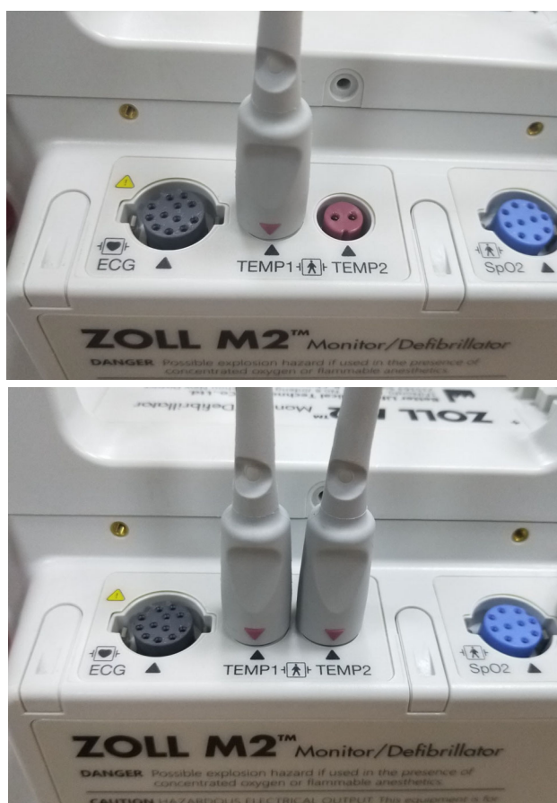
Figure 11-1 Connexion de la sonde de température à l'appareil ZOLL M2
