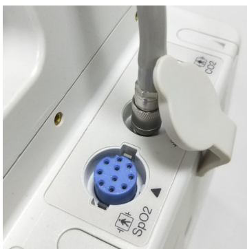
Figure 8-1 Fixation du tuyau de PNI à l'appareil ZOLL M2
