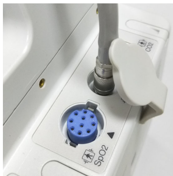
Rycina 8-1. Mocowanie przewodu NIBP do urządzenia ZOLL M2
