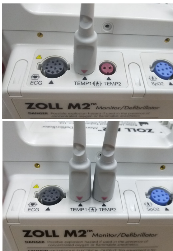
Rycina 11-1. Podłączanie sondy temperatury do urządzenia ZOLL M2
