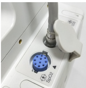
Figura 8-1 Collegamento del tubo NIBP all'unità ZOLL M2
