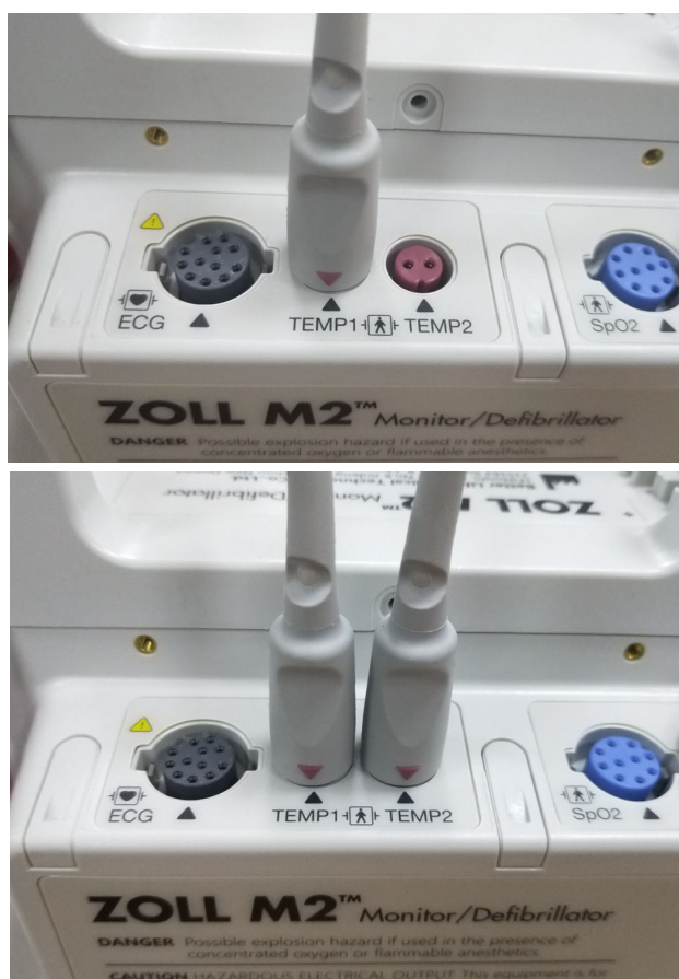
Figura 11-1 Collegamento della sonda di temperatura all'unità ZOLL M2
