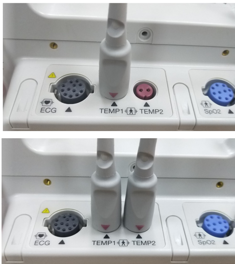
图 11-1 将体温探头连接到 ZOLL M2 设备
