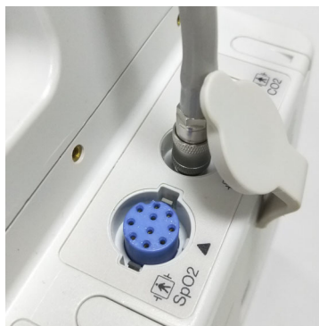
Obrázek 8-1 Připojení hadičky NIBP k jednotce ZOLL M2
