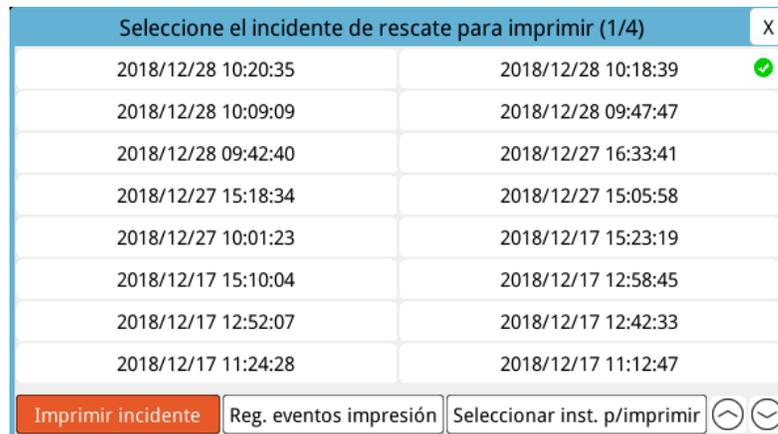
4. Gire el controlador de ajuste para resaltar el incidente que desee imprimir y, a continuación, pulse el controlador para seleccionarlo. Aparecerá una marca de verificación verde junto al incidente seleccionado.
