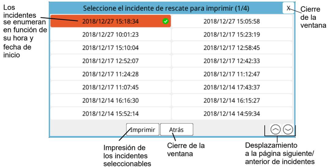
3. Gire el controlador de ajuste para desplazarse por la ventana y pulse el controlador para seleccionar un incidente. Una vez seleccionado el incidente, se mostrará una marca de verificación de color verde junto a este.
