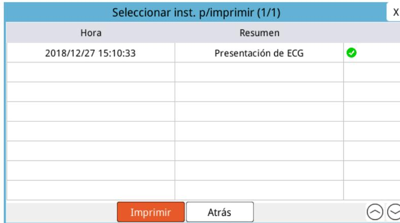
6. Gire el controlador de ajuste para resaltar una instantánea y, a continuación, pulse el controlador para seleccionarla. Puede imprimir más de una instantánea. Se mostrará una marca de verificación de color verde al lado de las instantáneas que haya seleccionado para imprimir.
