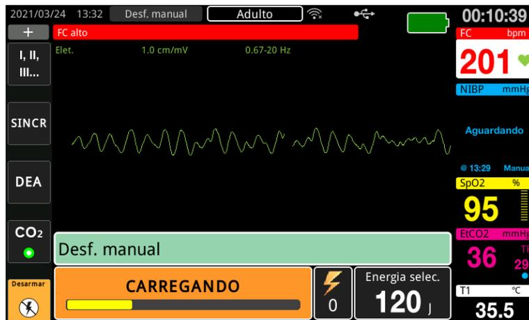
El gráfico de barras de energía en la parte inferior de la pantalla resalta el nivel de carga hasta que llega a la energía seleccionada. Cuando la unidad esté totalmente cargada, el tono cambiará a un tono preparado para la carga continua, y el mensaje *PREPARADO* se mostrará en la parte inferior de la pantalla. El indicador de carga en la pala apical se ilumina cuando la unidad ZOLL M2 está preparada para proporcionar la energía de desfibrilación al paciente.
