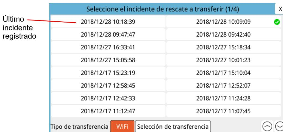
4. Gire el controlador de ajuste para seleccionar **WiFi** como el Tipo de transferencia; luego, pulse el controlador para seleccionarlo.
