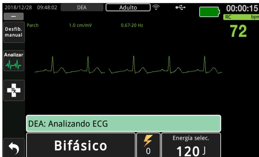
Mientras se analiza el ECG del paciente, se muestra el mensaje *Analizando ECG*. Una vez completado el análisis, la unidad indica si es recomendable o no administrar una descarga.
