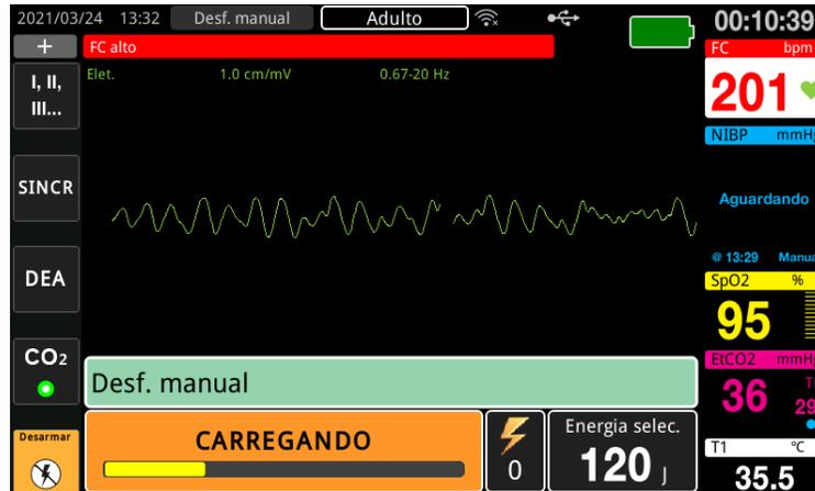
El gráfico de barras de energía en la parte inferior de la pantalla resalta el nivel de carga hasta que llega a la energía seleccionada. Cuando la unidad esté totalmente cargada, el tono cambiará a un tono continuo preparado para la carga, el mensaje *LISTO* aparecerá en la parte inferior de la pantalla y el botón **DESCARGA** del panel frontal se encenderá.
