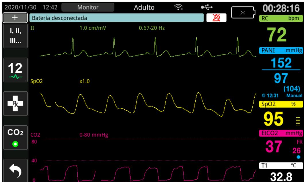
La pantalla de CO<sub>2</sub> de la unidad puede establecerse en %, mmHg o kPa. El rango de visualización de la forma de onda CO<sub>2</sub> se puede ajustar: gire el controlador de ajuste para resaltar el rango de visualización y pulse el controlador para seleccionarlo. Las opciones de rango de visualización disponibles son:
