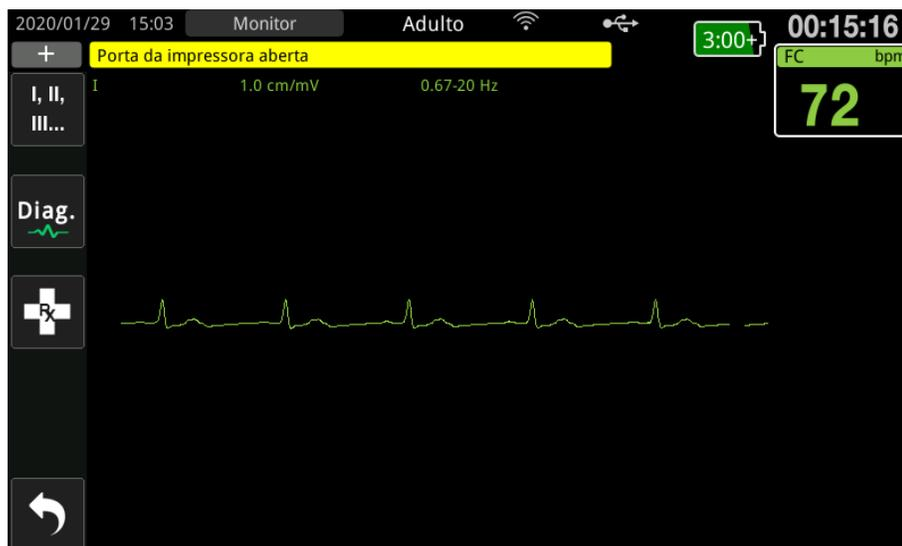
Figura 5-3 Tela de alarme de equipamento
