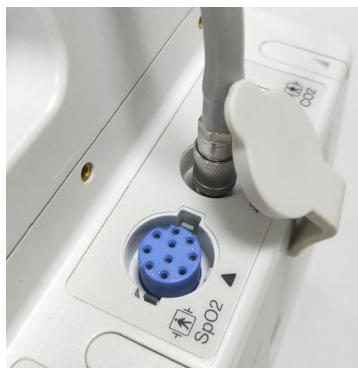
Рис. 8.1. Прикрепление шланга НИАД к прибору ZOLL M2
