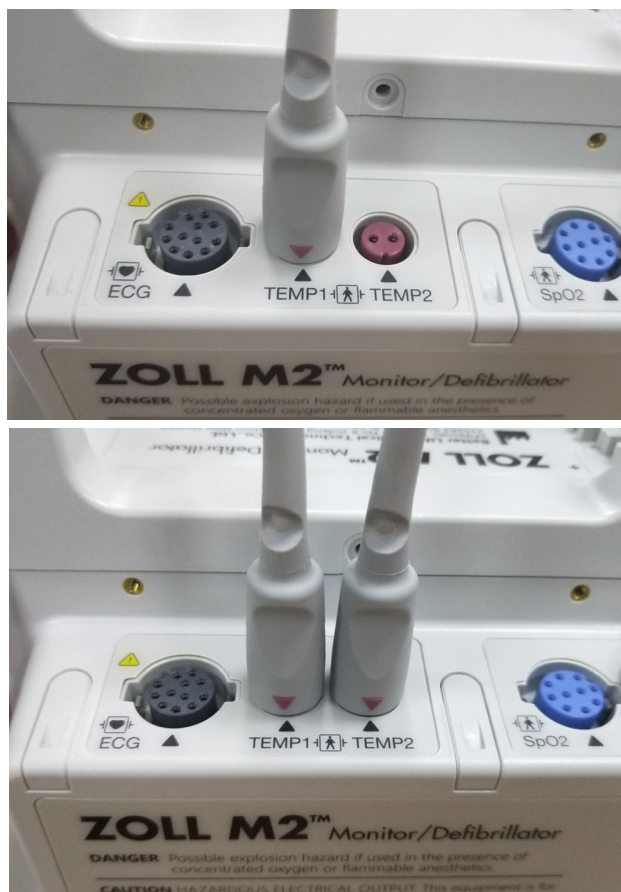
Рис. 11.1. Подключение датчика температуры к прибору ZOLL M2
