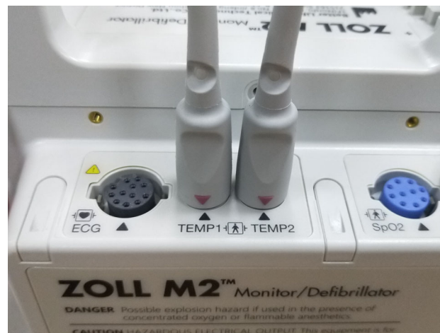
รูปที่ 11-1 การเชื่อมต่อหัวตรวจอุณหภูมิเข้ากับตัวเครื่อง ZOLL M2
