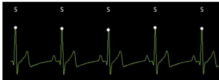
เครื่องหมาย S บ่งชี้คลื่น R แต่ละคลื่นที่ตรวจพบในระหว่างการซิงโครไนซ์
