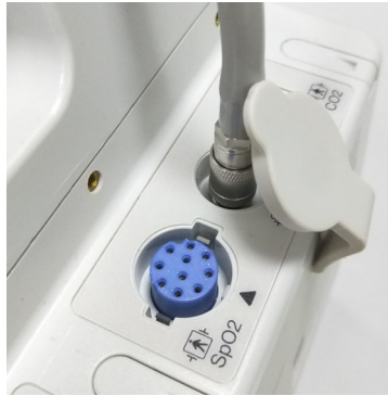
Şekil 8-1 NIBP Hortumunu ZOLL M2 Ünitesine Takma
