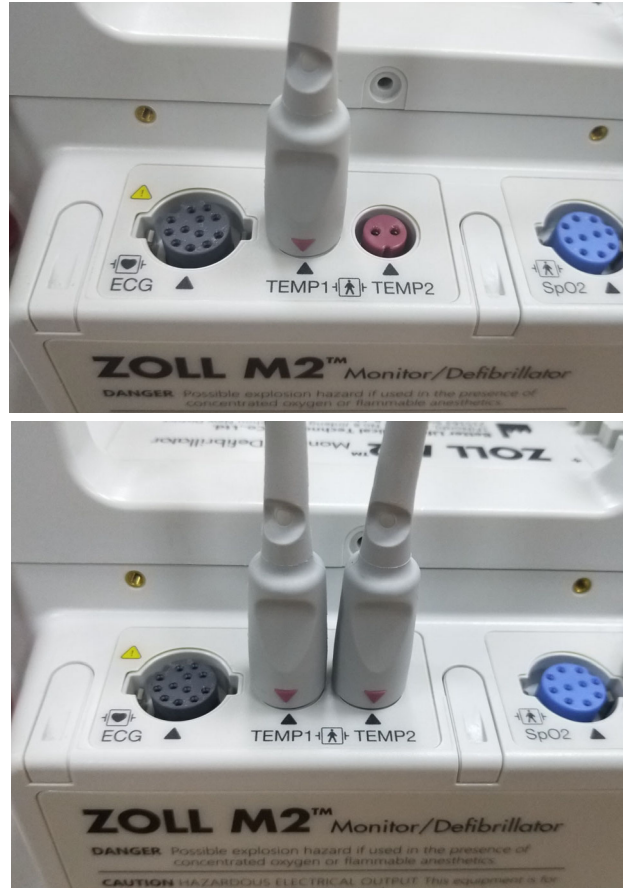
Şekil 11-1 Sıcaklık Probu ZOLL M2 Ünitesine Bağlama
