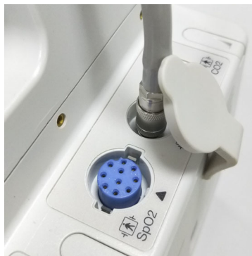
Gambar 8-1 Memasang Selang NIBP di Unit ZOLL M2
