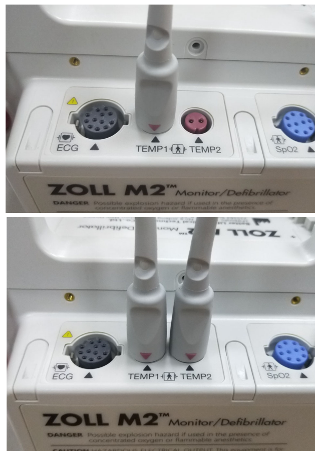
Gambar 11-1 Menyambungkan Alat Pengukur Suhu ke Unit ZOLL M2
