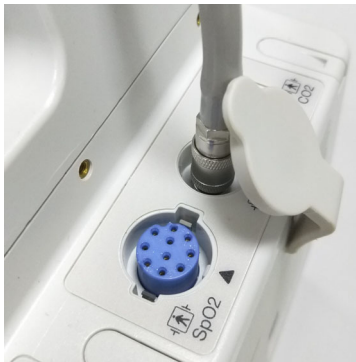
Gambar 8-1 Memasang Selang NIBP di Unit ZOLL M2
