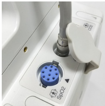
Hình 8-1 Gắn ống dẫn NIBP vào thiết bị ZOLL M2
