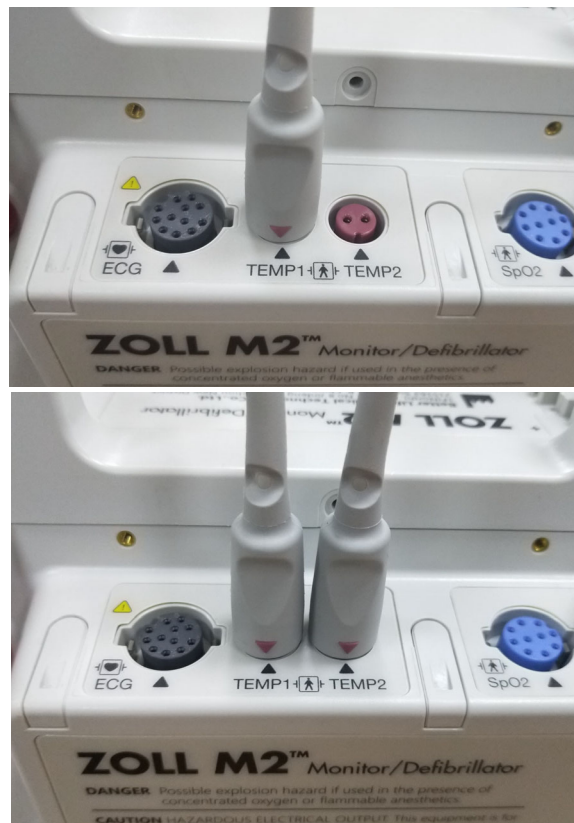
Рисунок 11-1. Підключення температурного датчика до приладу ZOLL M2
