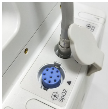
Рисунок 8-1. Під'єднання кабелю HIAT до приладу ZOLL M2
