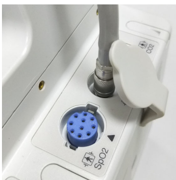
图 8-1 将 NIBP 软管连接到 ZOLL M2 设备
